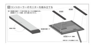
P8 **1**-**1** に **1**07-4 保護テープ2 個の両面に貼ってある剥離紙を剥し」とありますが、 提供パーツでは片面のみとなります。その剥離紙を剥がして **1**07-3 モニターの裏面に貼り付けてください。
