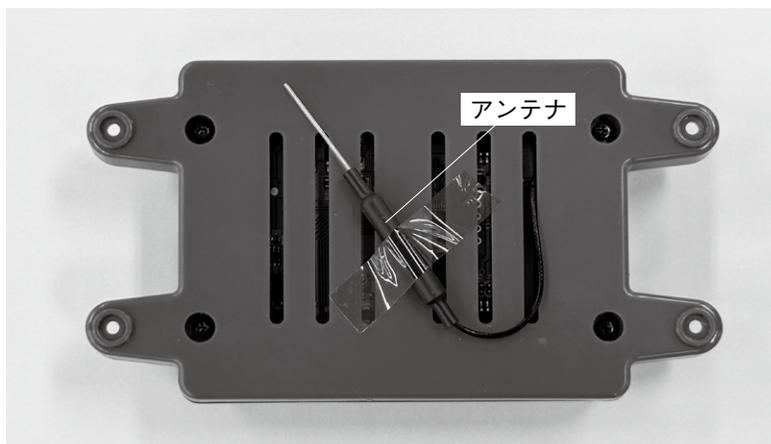
「106-基板」の底面にはアンテナがテープで固定されています。
