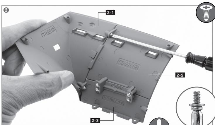
①で組み立てた船体と 2-1 艦首を写真のように組み合わせ、2-10 M2スプリングワッシャーをはめ込んだ PMネジ (M2.0×4mm) で2カ所を固定する。
