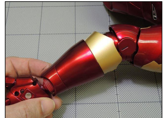
⑬前腕1 (内) を4本のネジE Mで固定して、 前腕1 (外) を取り付ける。
