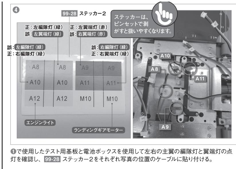
①で使用したテスト用基板と電池ボックスを使用して左右の主翼の編隊灯と翼端灯の点灯を確認し、**99-28** ステッカー-2をそれぞれ写真の位置のケーブルに貼り付ける。
