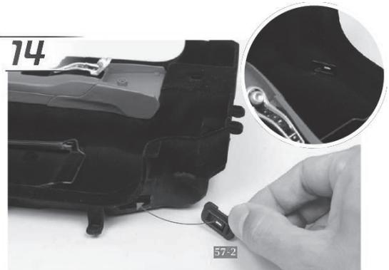
接着剤が乾く前に、57-2 (ハッチオープナー) をインテリアパネルに組み合わせる。インテリアパネルの右フロント側、写真の位置の穴に、外側からはめ込もう。
