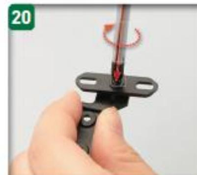
1番のプラスドライバーを使い、セットしたM2.3×6mmワッシャー付きビスをねじ込む。ステアリングクランクがスムーズに動くよう、ねじ込み加減を調整しよう。
