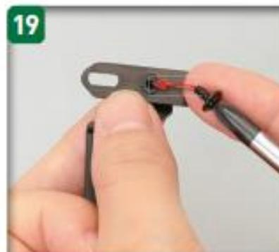
46号で提供したM2.3×6mmワッシャー付きビスを用意し、写真で示したビス穴にセットする。
