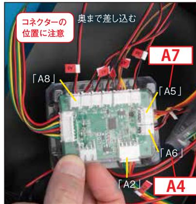
さらに基盤ボックス5に、「A2」「A4」「A7」「A8」のコネクタを取り付けます。
