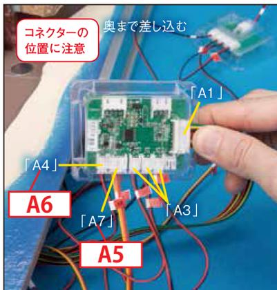
O. 基盤ボックス5に、「A1」「A3」「A5」「A6」のコネクタを取り付けます。
