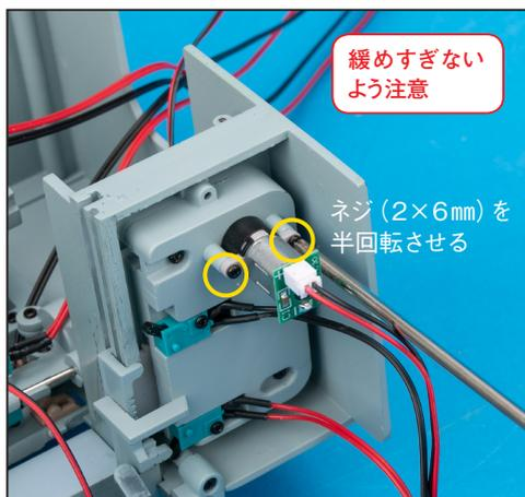
**1** サンダーバード2号滑走路を用意します。2号滑走路ギアボックスに取り付けたモーターの2カ所(黄○)のネジ(2×6mm)を確認し、きつく締めている場合は半回転させて少し緩めましょう。
