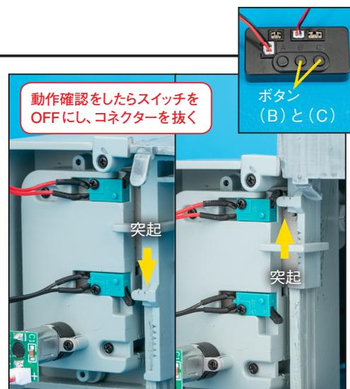
**3** 電池ボックスのスイッチをONにして、ターミナルのボタン(B)または(C)を押します。ゲートの上下の突起(黄矢印)がスイッチ部の外側に出ない範囲で動きます。動作確認が完了したら、ゲート上側の突起がスイッチ部に触れる位置で止めておきます。
