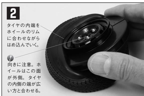
タイヤを引き伸ばしながらホイールのブロックを斜めに押し込み、タイヤの内側にホイールリングの片端をはめ込む。
