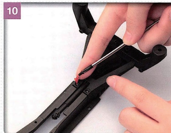
③ビス(Oタイプ)を用意し、写真で示したビス穴にセットする。このとき、シャシーフレームBの前側が浮き上がっているため、シャシーフレームAに押し付けておく。
