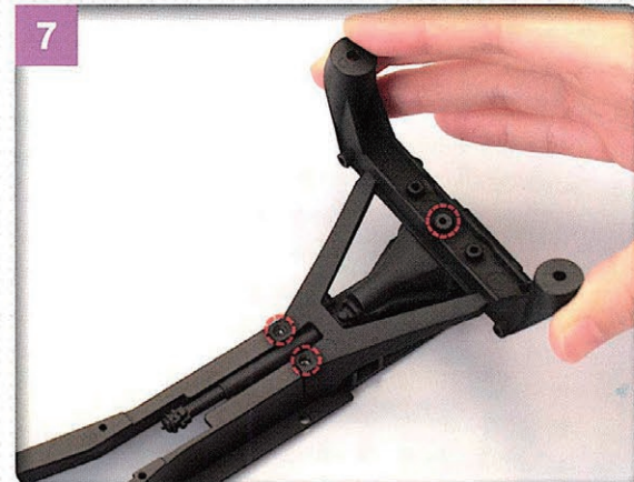
7 デフケースのポストの位置と、シャシーフレームAとBのビス穴の位置をそれぞれ合わせる。この段階では、ポストがシャシーフレームBの穴から突き出してしまうが問題はない。
