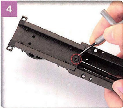
4 シャシーフレームを裏返し、写真で示したビス穴にもタップを立てる(計7カ所)。
