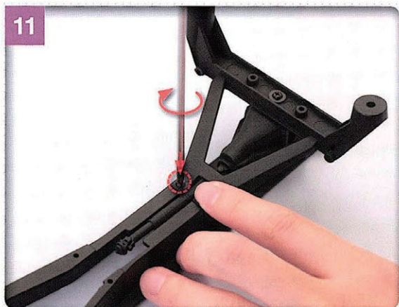
シャシーフレームBを押さえたまま、Oタイプのビスを1番のプラスドライバーでねじ込む。必要以上に力を入れてねじ込むと、ビス穴を傷めてしまうので注意しよう。
