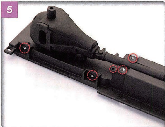
5 指定したビス穴にタップを立て終えた状態。ビス穴の中に金属の削りかすが残っている場合は、取り除いておこう。
