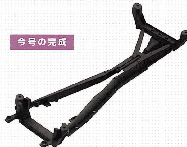
これで今回の作業は完了だ。2分割されたシャシーフレームが一体化され、実車と同じデザインの「Xボーンフレーム」が完成した。ダイキャスト製パーツならではの重厚感のある仕様だ。今後これに前後のサスペンションが組み付けられていくことになる。
