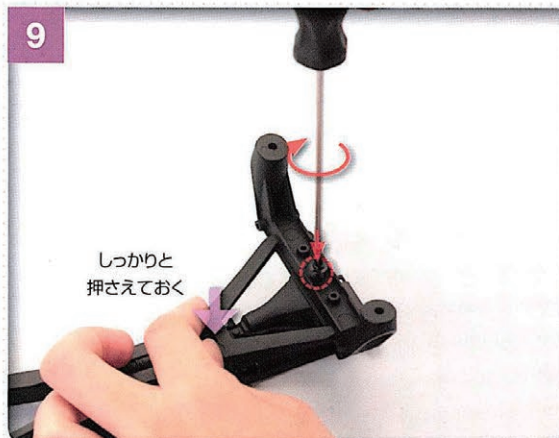
1番のプラスドライバーを使い、Qタイプのビスをねじ込む。このとき、シャシーフレームBが動かないようしっかりと保持しておく。なお、Qタイプのビスには“ワッシャー(円盤状の金属板)”が備わっているので、ワッシャーがポスト部の上面に密着するまでねじ込む。
