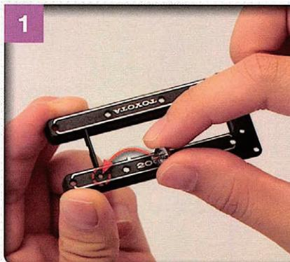
①ヘッドカバーを写真のように持ち、④オイルキャップを写真で示した穴にセットする。
