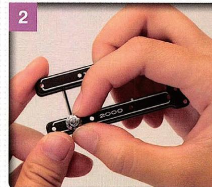
オイルキャップ裏側から突き出しているピンを、ヘッドカバーの穴へ真っすぐに差し込む。
