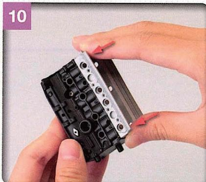
シリンダーブロック上部と、シリンダーヘッド(下)の取り付け位置を合わせ、そのまま押し込む。
