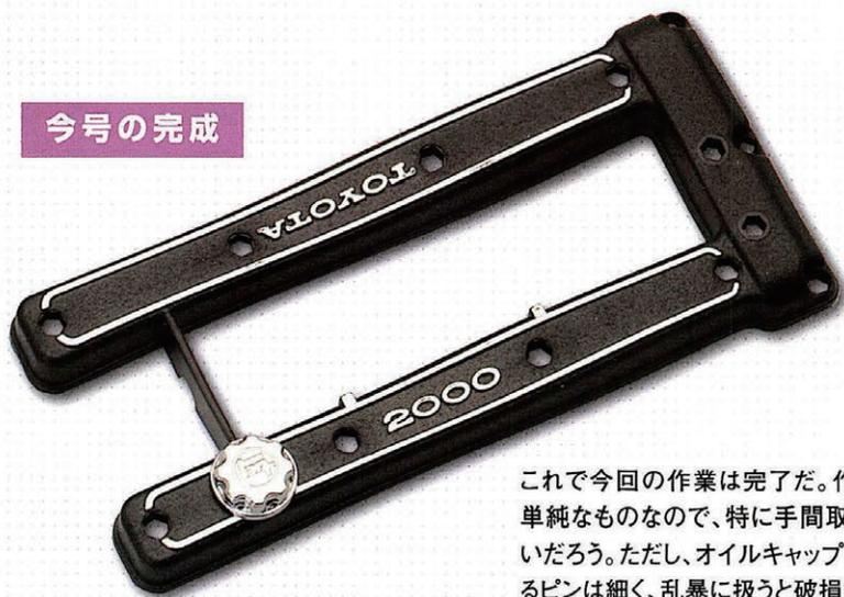
これで今回の作業は完了だ。作業自体は単純なものなので、特に手間取ることはないだろう。ただし、オイルキャップを取り付けるピンは細く、乱暴に扱くと破損する恐れがある。取り付けはくれぐれも慎重に扱おう。また、組み立てたパーツは次回の作業に備え、大切に保管しておこう。
