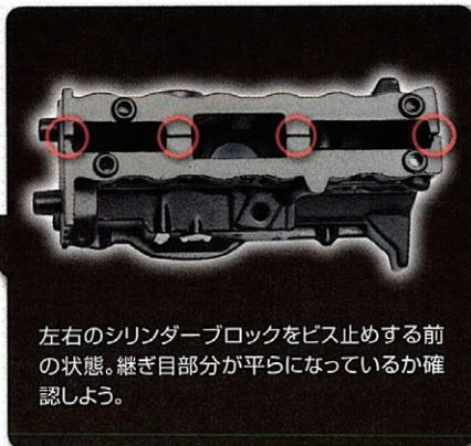
左右のシリンダーブロックをビス止めする前の状態。継ぎ目部分が平らになっているか確認しよう。
