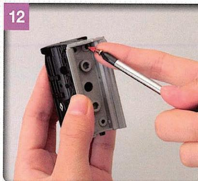
⑤Aタイプのビスを用意し、写真で示したシリンダーヘッド(下)のビス穴にセットする。Aタイプのビスは小さいので、1番の+(プラス)ドライバーの先端に取り付けた状態で作業するといいだろう。
