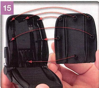
③運転席バックレスト(1)を用意し、裏面に設けられた取り付け部分の配置を確認し、次の手順で位置を合わせる。①中央部上下のポスト(円筒形の支柱)の穴と、バックレスト(2)にあるピン→②バックレスト(2)に設けられた2本のリブ(板状の成型部分)と、バックレスト(1)裏面の溝→③左右上下にある各2本のピンとポストの穴の位置に合わせてセットする。
