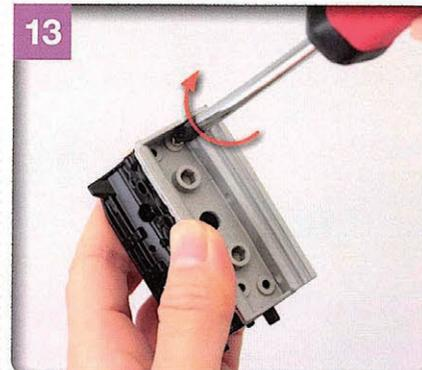
1番の+(プラス)ドライバーを使い、Aタイプのビスをねじ込む。このビスは非常に短いので、ねじ込みすぎるとビス穴を傷めてしまう。ドライバーを回す手応えが重く感じたら、ねじ込むのをやめよう。
