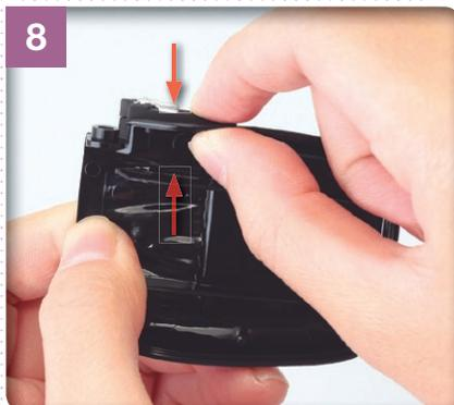
8 バックレストレバーと運転席バックレストの縁を挟むようにして持ち、そのまま真っすぐに押し込む。
