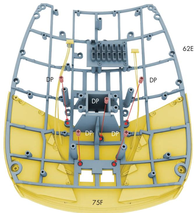
ステージ63で組み立てた**62E**バトルセクション上部ブラケットを用意し、**75F**バトルセクション・フロントパネルを合わせる。図のようにリード線をフレームに通し、ネジ**DP** 5本でネジ留めする。最後に、**77L**・**79G**バトルセクション・パネルライトを下図のように**61G**バトルセクション部プリント回路基板(PCB)に差し込む。
