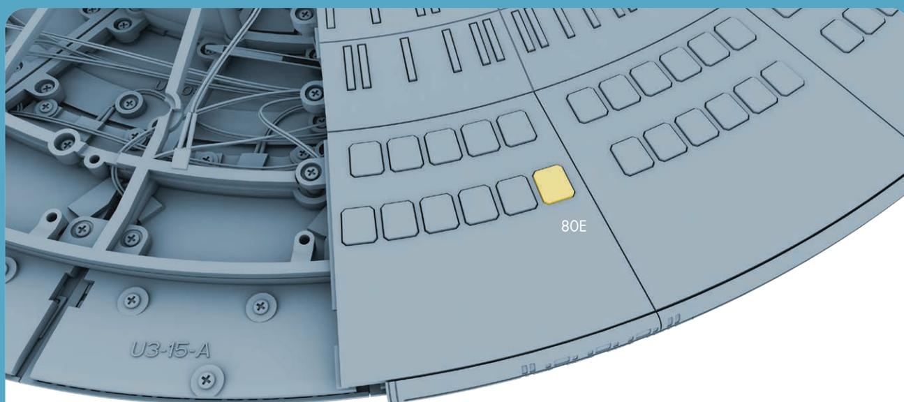
次に、**80E**脱出ポッドスクリーカバーを押し込み、くぼみのネジを隠す。
