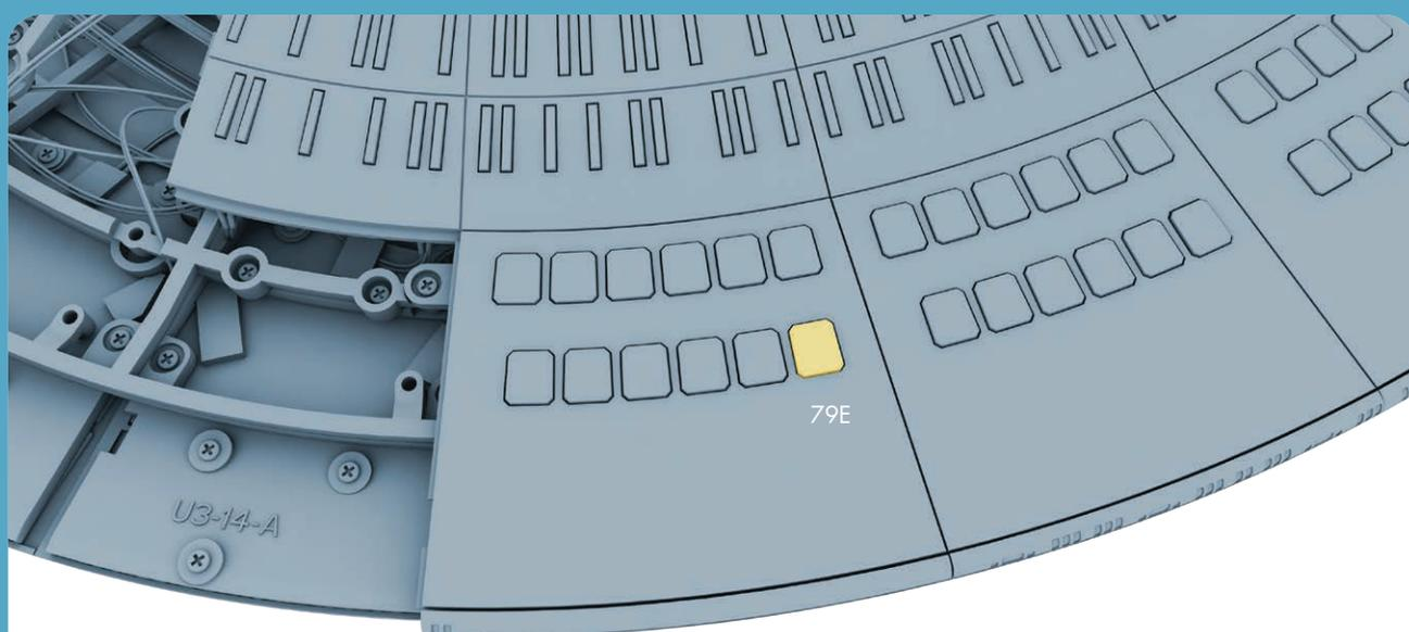
次に、**79E**脱出ポッドスクリーカバーを押し込み、くぼみのネジを隠す。
