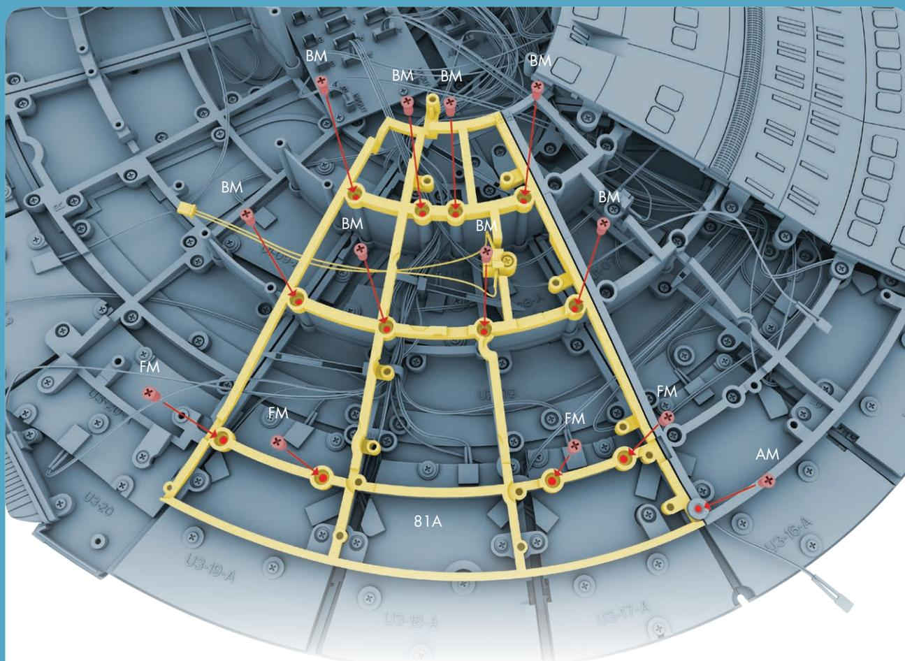
次に、ネジBM8本、ネジFM4本、ネジAM1本でネジ留めする。
