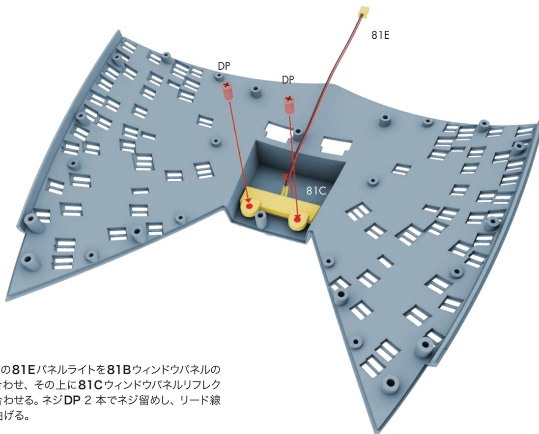
もう1本の**81E**パネルライトを**81B**ウィンドウパネルのピンに合わせ、その上に**81C**ウィンドウパネルリフレクターを合わせる。ネジ**DP** 2本でネジ留めし、リード線を折り曲げる。
