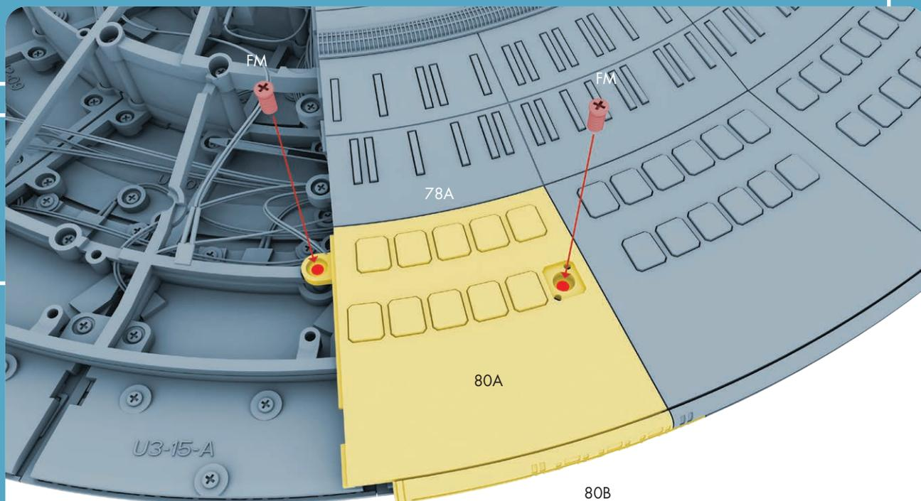
**80B**アウターパネル(L4-12)が円盤部上部のデッキパネルの端に重なるように、デッキパネルパーツを下部フレームに合わせ、ネジFM 2本でネジ留めする。
