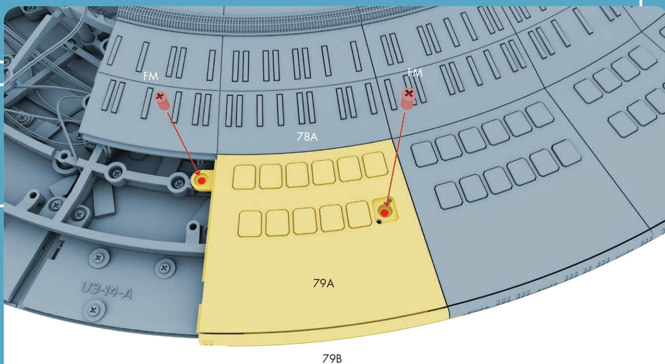
**79B**アウターパネル(L4-11)が円盤部上部のデッキパネルの端に重なるように、デッキパネルパーツを下部フレームに合わせ、ネジFM 2本でネジ留めする。
