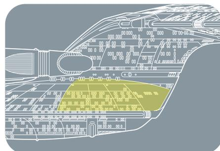
最後に、79B アウターパネル (L4-11) を図のようにデッキパネルの端に合わせて、ネジIM2本でネジ留めする。
