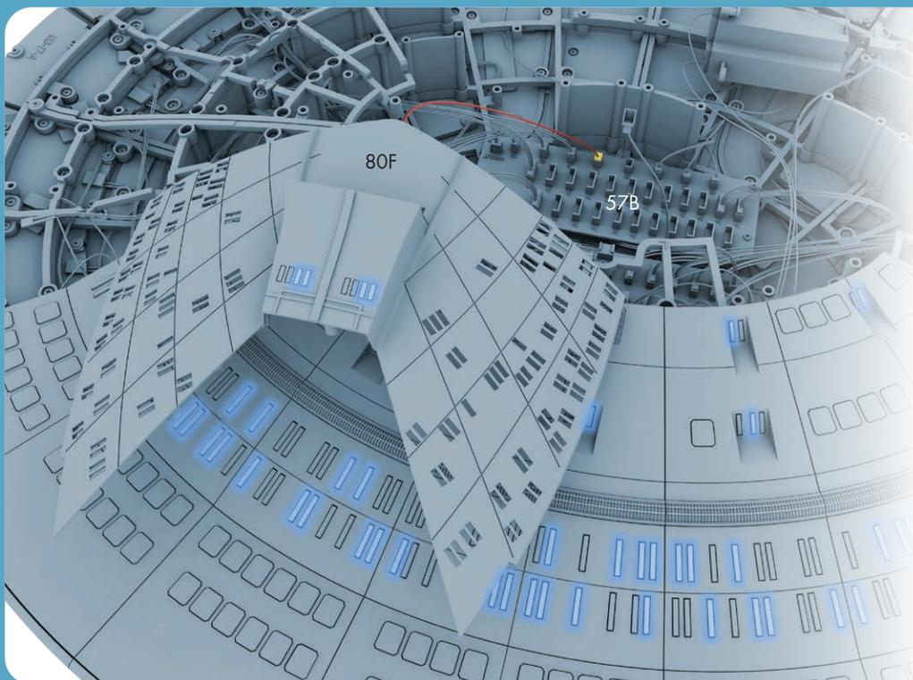
**81E**パネルライトを**57B**円盤部プリント回路基板(PCB)3の未使用の「B」の差し込み口に差し込み、円盤部電源スイッチを「ON」にして、取り付けしたライトが図のように点灯することを確認する。点灯を確認したらパネルライトの端子を回路基板から取り外す。
