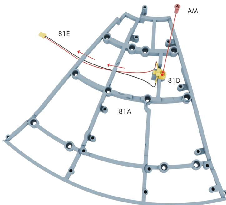
次に81A下部フレーム(2)の溝にLEDをはめ込み、図のようにリード線をフレームに通す。81D LEDブラケットを合わせ、ネジAM1本でネジ留めする。
