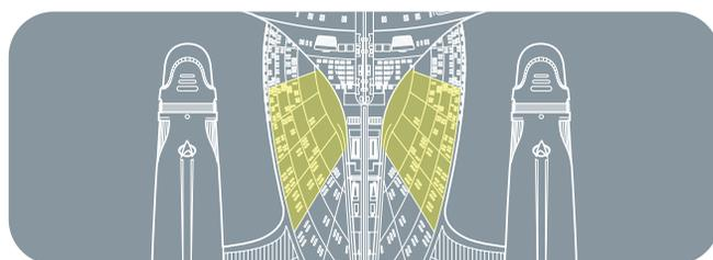
次に、**82C** 脱出ポッドカバーブラケット(1)と**82D** 脱出ポッドカバーブラケット(2)を脱出ポッドカバーの上に合わせ、ネジAM3本でネジ留めする。
