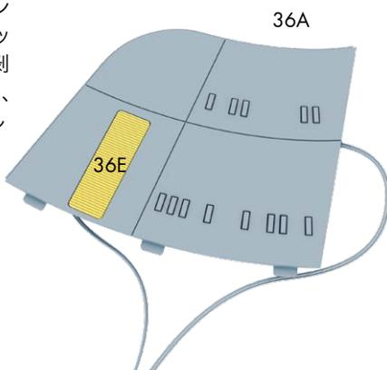
新しく取り付けしたライトの点灯テストを行う。**03H**バッテリーパックを**03M**プリント回路基板(PCB)の「E」の差し込み口に差し込んだ状態で、**36H**パネルライトを「B」に差し込む。
