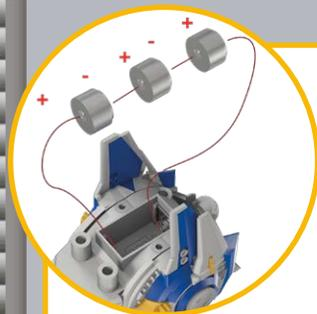
ボタン電池は片面が+ (プラス)、片面が- (マイナス) になっている。作業中にショートさせないように、側面を持つように注意する。
