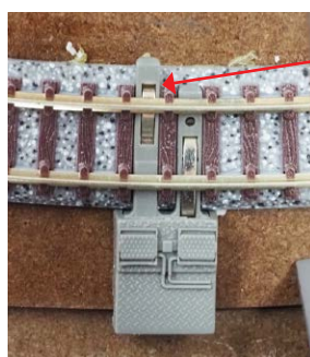
レールの外側まで、フィーダーの金具が見えるように、しっかりと差し込む
