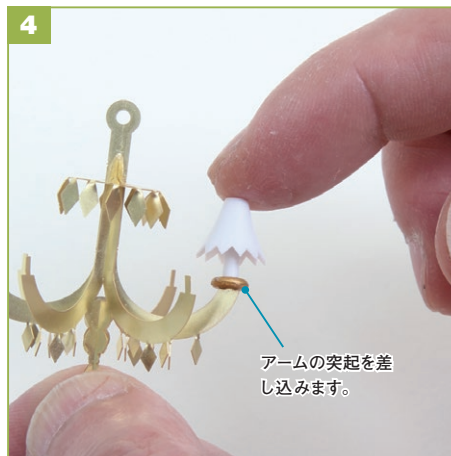
アームの突起を②のランプの穴に差し込みます。
