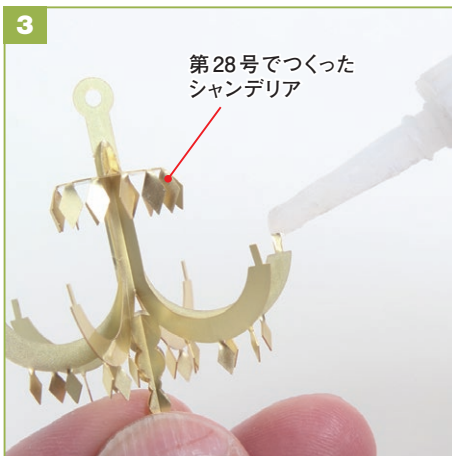
第28号でつくったシャンデリアのアームの先の突起に瞬間接着剤をつけます。
