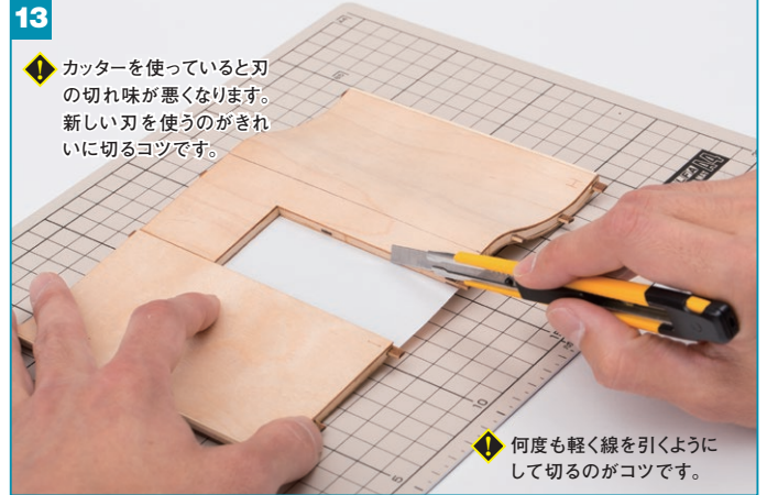
壁を裏返し、開口部の壁紙をカッターナイフで切ります。写真のように、開口部の端に沿わせてカッターナイフを垂直に当て、何度も軽く線を引くようにして切ります。
