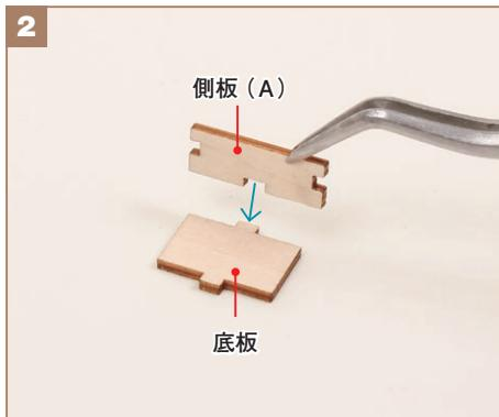
底板の突起と側板(A)の切り込みをかみ合わせ、ボンドで接着します。
