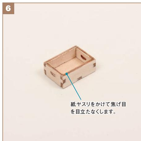
着色します。まず、側板(A,B)と底板の厚みに紙やすりをかけて、焦げ目を目立たなくします。
