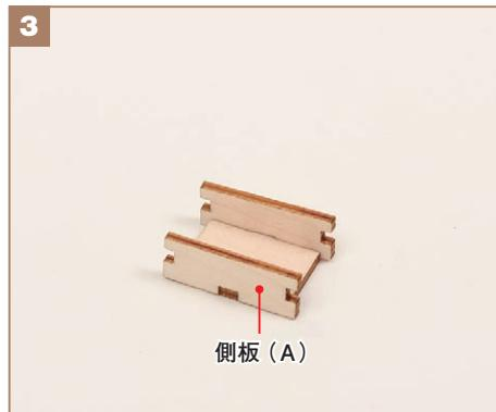
同様に、底板の反対側に残りの側板(A)をボンドで接着します。
