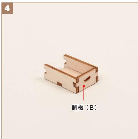
左右の側板(A)の切り込みに側板(B)の突起を差し込み、ボンドで接着します。
