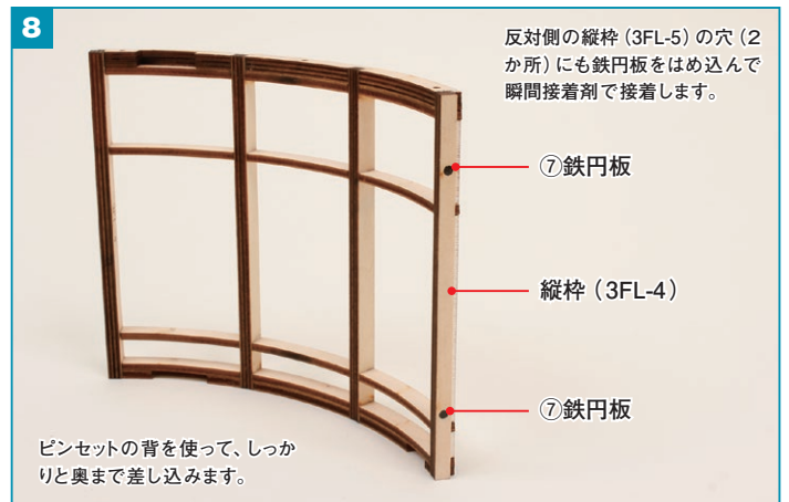
左右の縦枠 (3FL-4と3FL-5) の外側の穴に⑦鉄円板をはめ込み、瞬間接着剤で接着します。
