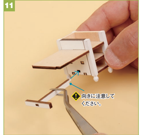
11 仕切り板の穴に、⑩で組み立てた貫を差し込み、ボンドで接着します。
