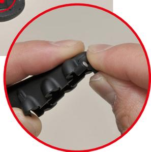
●ターボチャンバーとインジェクションユニットA（上）を仮組みしたように組み合わせ、穴の反対側から見える突起先端(黄矢印)にプラモデル(スチロール樹脂)用接着剤をつまようじでたらすようにして少量塗る。
