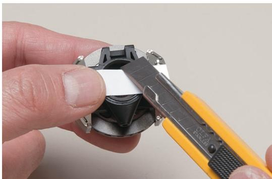
●2枚になった紙をブレーキディスクの部分からピンセットでそれぞれ抜き取る。
