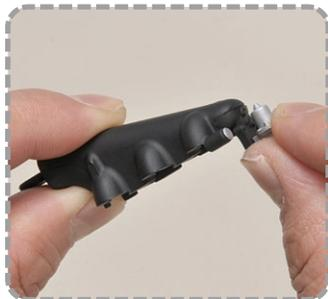
●ターボチャンバーの赤点部分(突起の最後部の面)と赤線で示した部分(段差との境目)に瞬間接着剤をつまようじで少量塗る。仮組みしたようにターボチャンバー（後）を組み合わせ、完全に接着するまで指で1分ほどおさえる。
