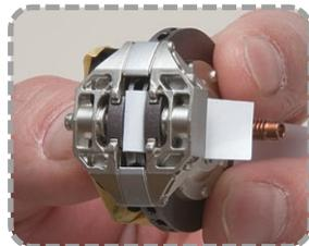
■紙をはさみ組み合わせることで、ブレーキディスクとブレーキパッドの間に適度なすき間をつくる。
