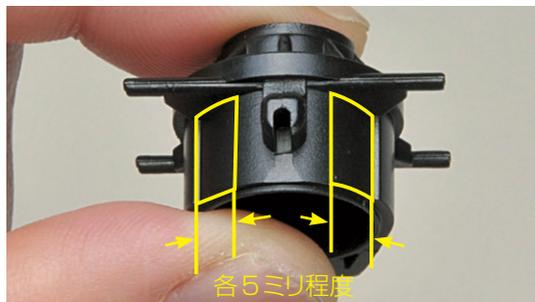
● フロントブレーキハブの青線で囲んだ部分(3ミリ幅程度)の塗装をカッターの刃のない部分で円筒全周はがす。
