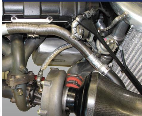
水冷式オイルクーラーは、エンジンオイルの温度管理をラジエーターからの冷却水で行っている。空冷式とは異なり、エンジンが動いていれば機能する仕組みとなっている。マクラーレン社への取材により、本モデルのディテールが再現できた。また、ラジエーター(右)の上部同様に、プレートも再現した。
