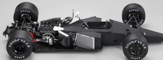
■ 後の号で、モノコック、エンジン、ギアボックスの下部にアンダーパネルが取り付けられる。
