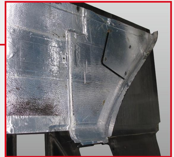
▲アンダーパネル(後)上面の拡大図。遮熱シートは、その形状に合わせて、さまざまに貼り合わせられている。
