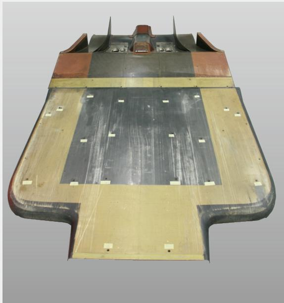
▲アンダーパネルの底面。底面に突起物はなく、後部に整流板がある。
