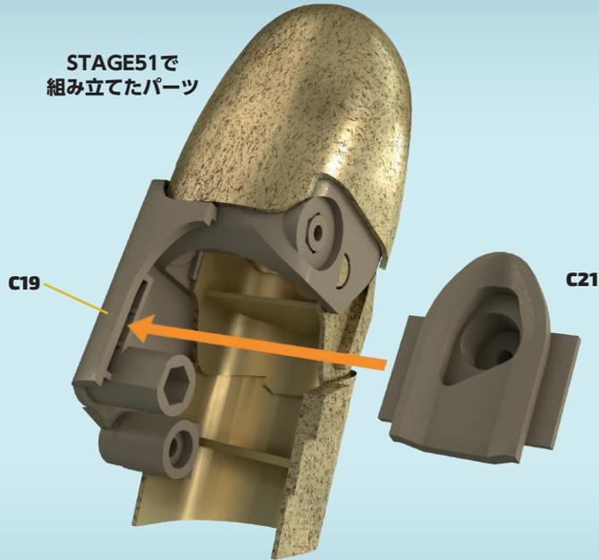
**1** これまでに組み立てた中指を用意する。C19の溝部分にパーツC21を図のように挿入する。パーツの向きに注意する。
