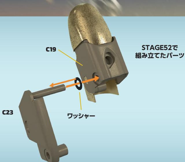
**1** STAGE52で組み立てたパーツを用意する。図のようにC19の横穴にワッシャーを入れる。C23内側にある長いピンをC19の穴にはめ込む。きっちり押し込む。
