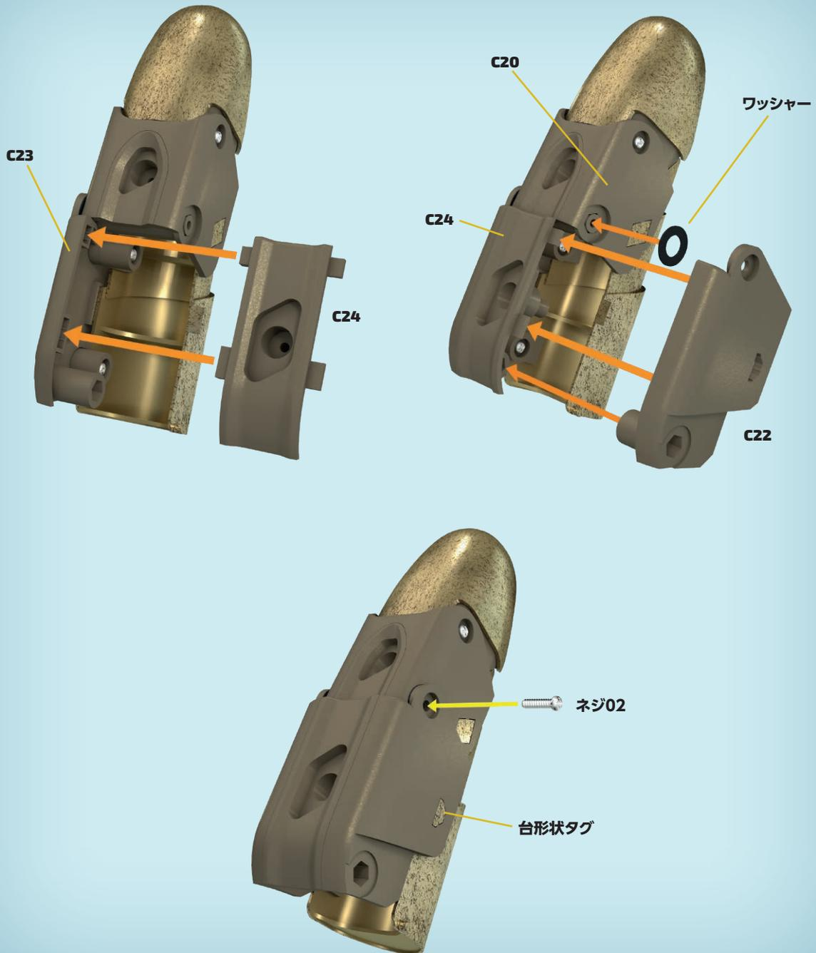
**4** 図のように、C24のタブをC23の長方形の穴にはめ込む。C20の横穴にワッシャーを入れ、C22をC24にはめ込む。A28の台形状タブに収まっているかを確認して、ネジ02で固定する。
