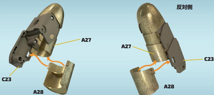
**2** STAGE52で保管しておいたA28を用意する。A28側面にある半円形の突起部分をC23の半円形の穴に入れる。A28がA27の上に収まり、固定されたか確認する。
