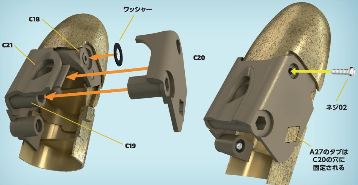
**2** C18側面の穴にワッシャーを入れ、落ちないように注意する。その上にC20をはめ込み、関節の内側を完成させる。C21にはC20の溝にはまるタブがあり、A27の台形状タブは図のようにC20の穴にはまる。ネジ02で固定する。
