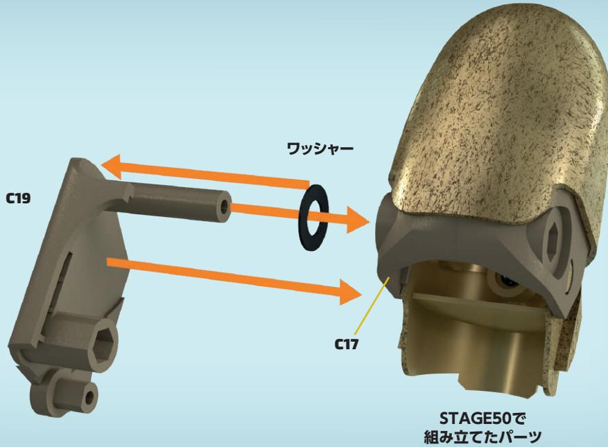
**1** C19の長い突起部分に、図のようにワッシャーを挿入し、中指の先端部分に挿入する。注：中指を図と同じ向きにした場合、突起部分は左から差し込み、最後まで押し込む。
