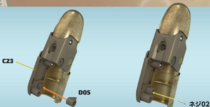
**3** 図のように、D05をC23内側の短いピンの上に置き、A28をネジ02で固定する
