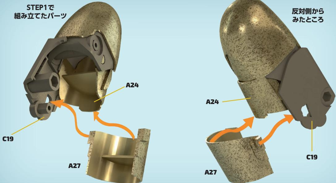
**2** A27の両側には、異なる台形状のタブがある。A27を中指の下側にき、A27のタブをC19の凹みにはめ込む。A27がA24の前面にかかるように。
