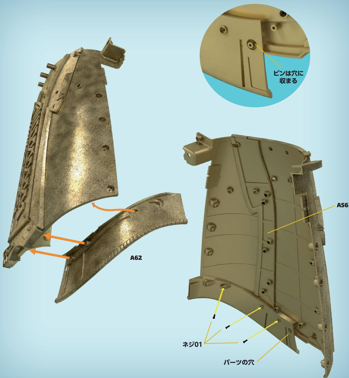
A62は、これまでに組み立てた前腕部内側に取り付ける。図のように、穴のあいた3本のピンを穴にかみ合わせる。内側から3本の01ネジで固定する。
