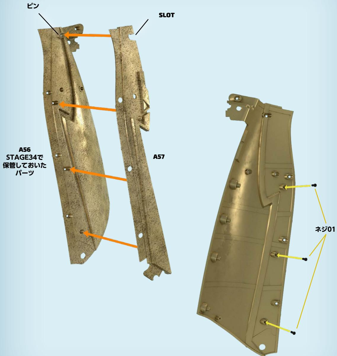
**1** STAGE34で保管しておいたA56を用意する。A57は外側に置く。A56にはA57の穴にはまる3つのピンが内側に、また上側にもう一つ穴がある。A57の位置が決まったら、01ネジ3本で固定する。パーツは大きくて硬いので、ネジはできるだけまっすぐに入れ、少しずつ確実に締めていく。
