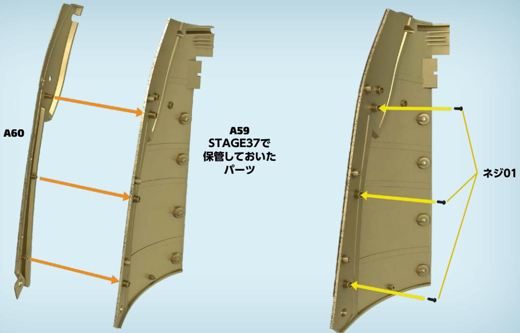
**1** A60を (STAGE37で保管しておいた) A59にはめる。A60の3本のピンをA59の3つの穴に合わせる。内側から01ネジ3本で固定する。パーツは大きくて硬いので、ネジがまっすぐに入るように注意する。パーツが固定されるまで、少しずつネジを締めていく。
