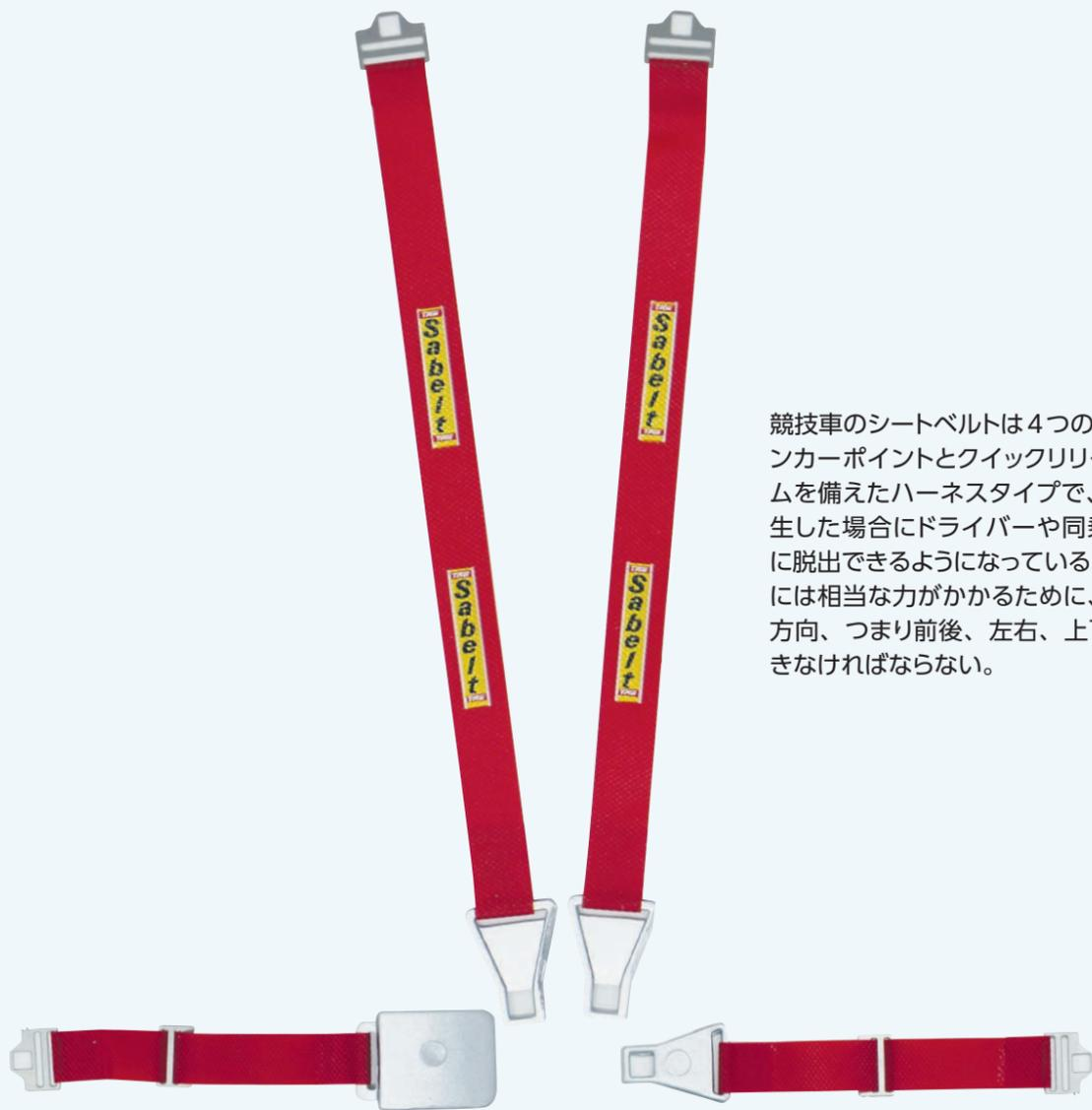
競技車のシートベルトは4つの独立したアンカーポイントとクイックリリースシステムを備えたハーネスタイプで、事故が発生した場合にドライバーや同乗者がすぐに脱出できるようになっている。ハーネスには相当な力がかかるために、すべての方向、つまり前後、左右、上下に保持できなければならない。
