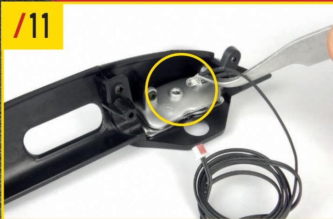
ダッシュボードを用意する。81-11(ケーブル1、赤いコネクタが付いている)のLEDライトをパネルの穴に差し込む。ケーブルを傷つけないように注意しよう。
