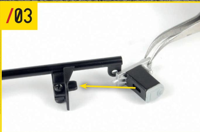
写真のように向きを合わせて、ワイパーモーターをブラケットに取り付ける。
