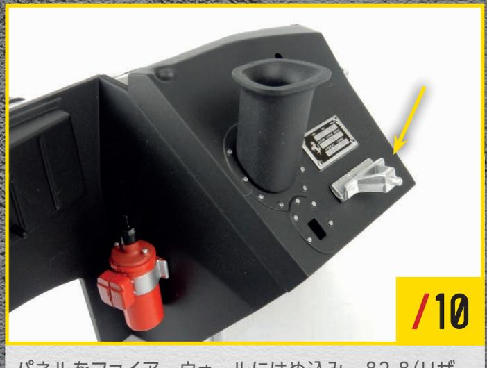
パネルをファイアーウォールにはめ込み、82-8(リザーバーブラケット)を写真のように取り付ける。
