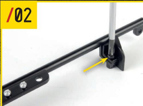
STAGE 80 で組み立てたダッシュボードサポートを用意し、81-3(モーターブラケット)を写真のようにネジBで固定する。
