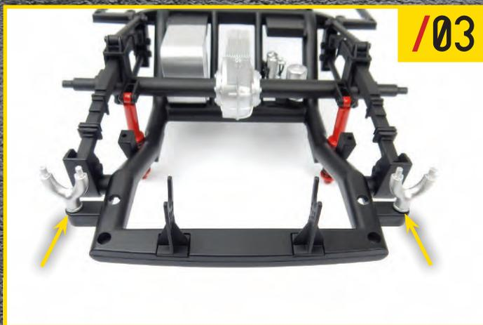
写真のように、46-4(排気クランプ)2点をそれぞれ取り付ける。
