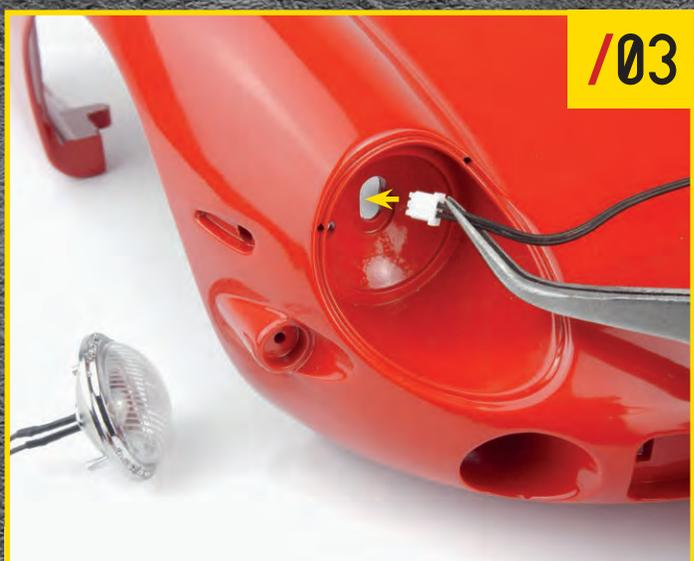
48-3(ケーブル)のもう一方の端にあるコネクタを、ボディの右ヘッドライトのくぼみに後部にある穴に通す。
