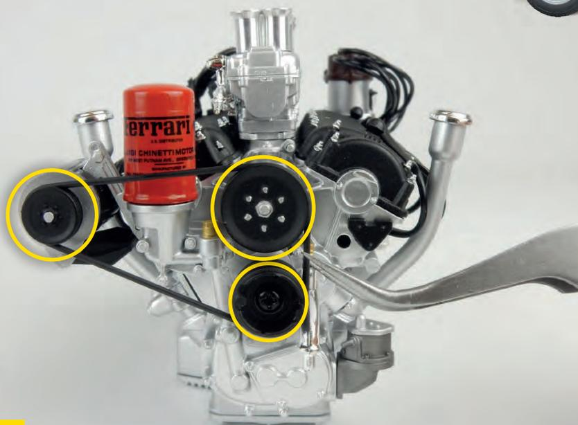
ピンセットを使ってねじれないように注意しながら、写真のように45-3(ファンベルト)をプーリーに取り付ける。エンジンブロック前方にある3つのプーリーがすべて連結していることを確認しよう。
