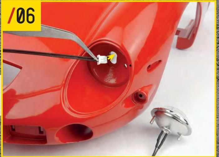
47-3(ヘッドライトハウジング)がヘッドライトのくぼみに達するまで、ケーブルを押し込む。レンズ内の印が、写真の赤いマークにある向きと同じであることを確認する。
