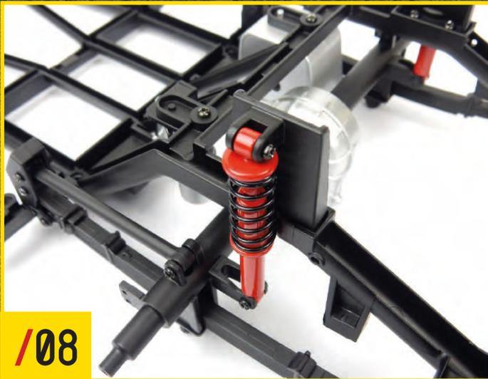
手順 06と07と同様に、46-1(左ショックアブソーバーブラケット、「L」と印字されている)をシャーシの左側に取り付け、それぞれのショックアブソーバーを固定する。
