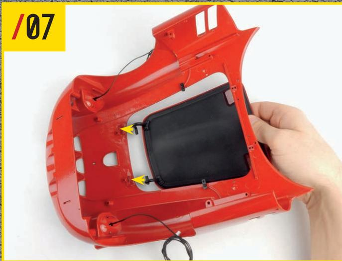
**STAGE 11** で作業したエンジンフードを用意する。写真のように向きを合わせて、ボディ前部に取り付ける。ヒンジを適切な位置に挿入すること。
