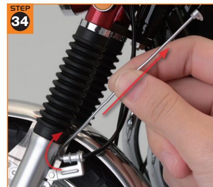
フロントフォーク左側面の写真で示した穴へ、曲げた先端部分を3mm程度差し込む。押し込み過ぎると、反対側に取り付けたホースが押し出されてしまうので注意しよう。
