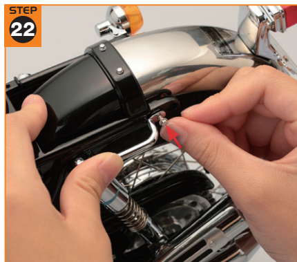
サイドグリップ後端のビス穴に、57号で提供したWタイプのビスを差し込む。こちら側はサイドグリップ分の厚みがあるので、樹脂ワッシャーを差し込む必要はない。
