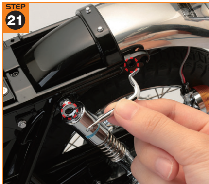
②サイドグリップを用意し、写真の向きで前後のビス穴にセットする。
