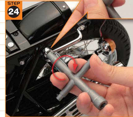
23号で提供したFタイプのビスを⑬と同様クロスレンチにセットして、サイドグリップ前側のビス穴へねじ込む。
