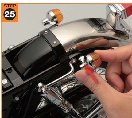
取り外したリヤウinker左を再び取り付け。ケーブルを傷めないよう注意しよう。
