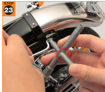
クロスレンチを使い、Wタイプのビスをねじ込む。このとき、サイドグリップの前側が動かないよう押さえておくこと。
