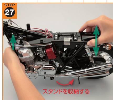
メインフレームの前側を少し持ち上げるような状態でメインスタンドを収納し、リヤ部分を軽く押してサスペンションの作動状況を確認しよう。左右のリヤダンパーが作動していればOKだ。
