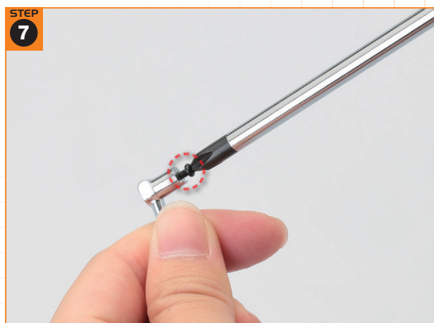
1番の+(プラス)ドライバーを使い、ビスの長さの半分程度までねじ込む。その後、ドライバーを左に回してビスを抜き取る。
