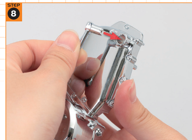
⑧ミッション&ダイナモケースカバーを用意し、写真に示した穴へ、ギヤチェンジペダルの付け根部分を差し込む。
