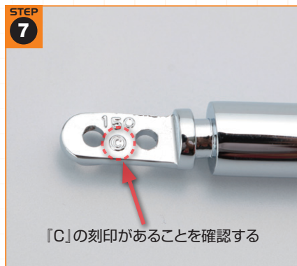
STEP 7 ①エキゾーストパイプ1番を用意し、先端にビス穴が開けられている側をチェックする。写真のように「C」の刻印があればOKだ。
