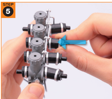
STEP 5 指先で真っすぐに押し込み、インシュレーターCをキャブレターに固定する。
