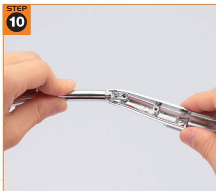
STEP 10 エキゾーストパイプの取り付け部分にはリング状の突起が設けられているので、そこにポストの先端を確実にはめ込む。
