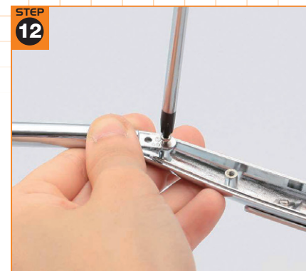
STEP 12 1番のプラスドライバーを使い、Pタイプのビスをしっかりと締め込む。
