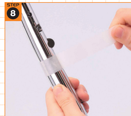
STEP 8 前回の作業で仮組みしたエキゾーストマフラーを用意し、マスキングテープをゆっくりとはがして、パーツを2つに分けておく。
