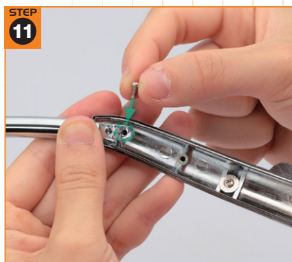
STEP 11 Pタイプのビスを用意し、エキゾーストパイプのビス穴にセットする。
