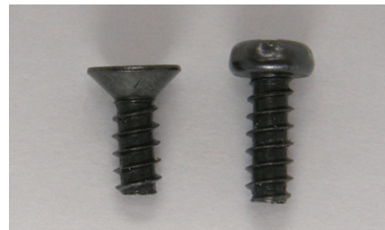
左が「皿ビス」、右が「ナベビス」だ。皿ビスは、取り付けした面を平らに仕上げたい場合や、ビス部分を隠したい、またはより強固な固定が必要な場合に使用される。
