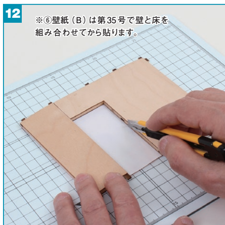
壁を裏返し、開口部の壁紙をカッターナイフで線を引きくようにして切ります。
