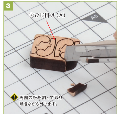
次に、⑦ ひじ掛け (A) を板から外します。板が厚いので、周囲の板を割って取り除きながら外すとよいでしょう。
